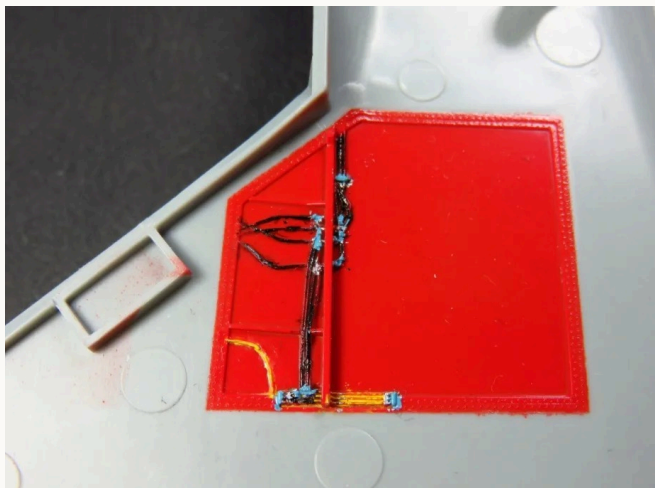
Un logement de train peint en rouge, gaines et fils ajoutés d'après l'avion réel. A gear bay painted red, with hoses and wiring added from the real aircraft.
