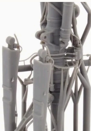
Les trains Minibase en résine imprimée, « une tuerie », avant les casses. The Minibase 3D-printed resin landing gear, "a killer", before the breakages.
